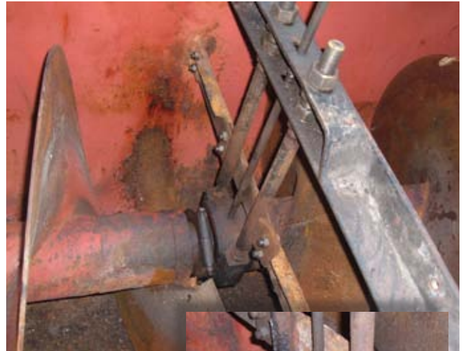
Schneckenförderer mit Gleitlagerung vor dem Umbau
