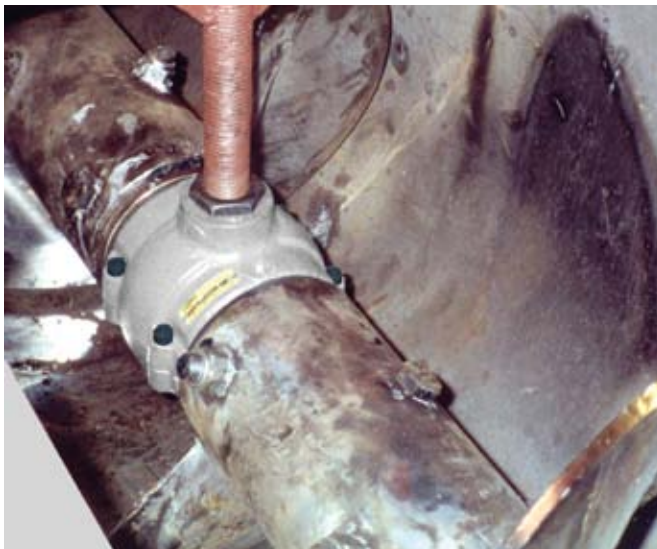
Hängelagereinheit in einem Schneckenförderer
