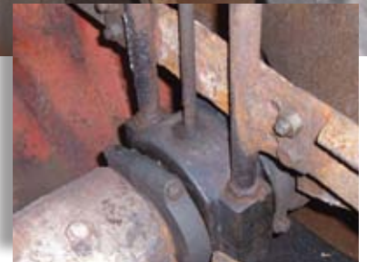
Schneckenförderer mit Gleitlagerung vor dem Umbau
